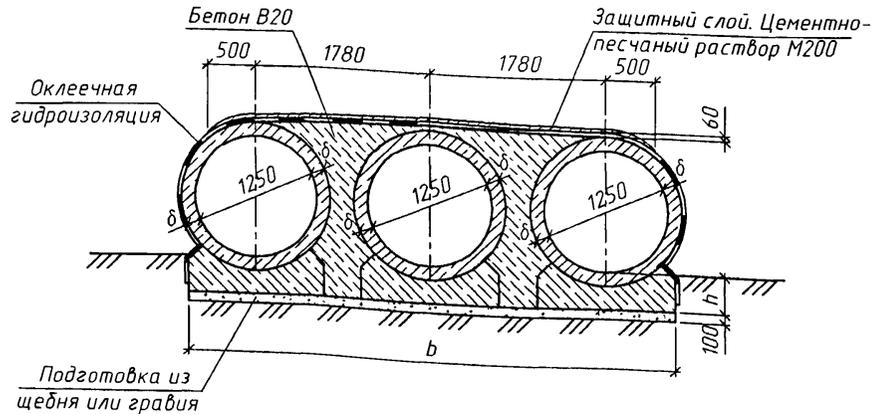
1. Звенья труб устанавливаются на блоки фундамента по слою цементного раствора М200 толщиной 20мм.
