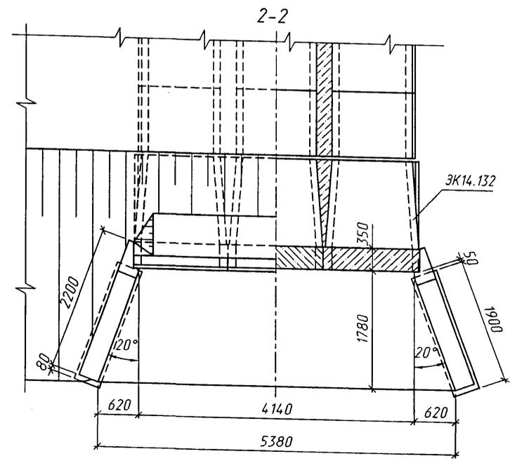
1. Звенья труб устанавливаются на блоки фундамента по слою цементного раствора М200 толщиной 20мм.
