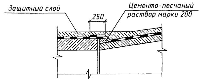
Гидроизоляция труб принята в соответствии с "Инструкцией по устройству гидроизоляции конструкций мостов и труб на железных, автомобильных, и городских дорогах" (ВСН 32 - 81).
