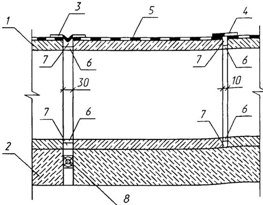
Конструкция гидроизоляции стыка секций при битумной мастичной армированной (оклеечной) гидроизоляции
