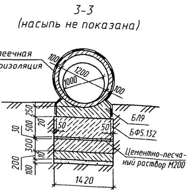
Спецификация блоков на оголовки
