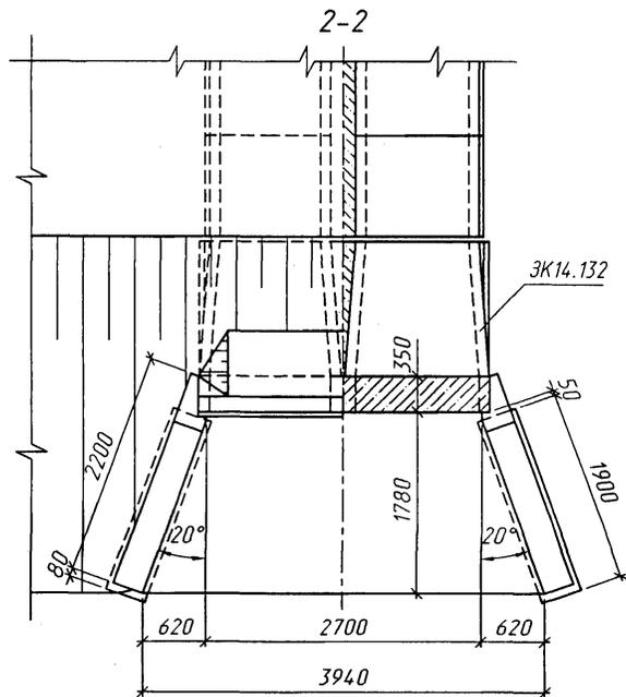
1. Звенья труб устанавливаются на блоки фундамента по слою цементного раствора М200 толщиной 20мм.
