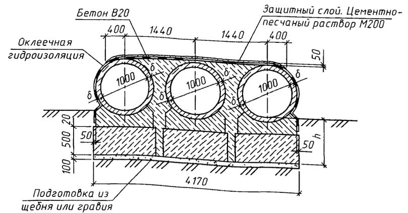
1. Звенья труб устанавливаются на блоки фундамента по слою цементного раствора М200 толщиной 20мм.
