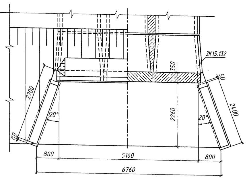
1. Звенья труб устанавливаются на фундамент по слою цементного раствора М200 толщиной 20мм.
