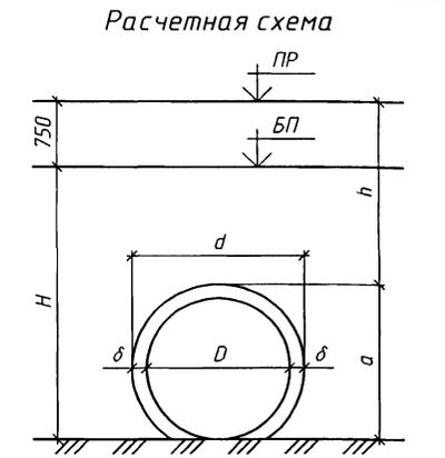
1. Нагрузки на звенья труб определены в соответствии с требованиями СНиП 2.05.03-84\*.
