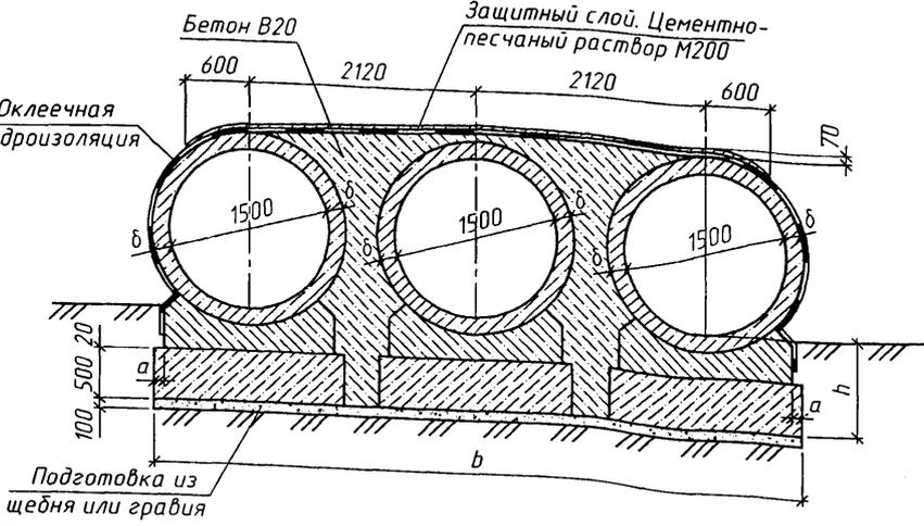
1. Звенья труб устанавливаются на блоки фундамента по слою цементного раствора М200 толщиной 20мм.
