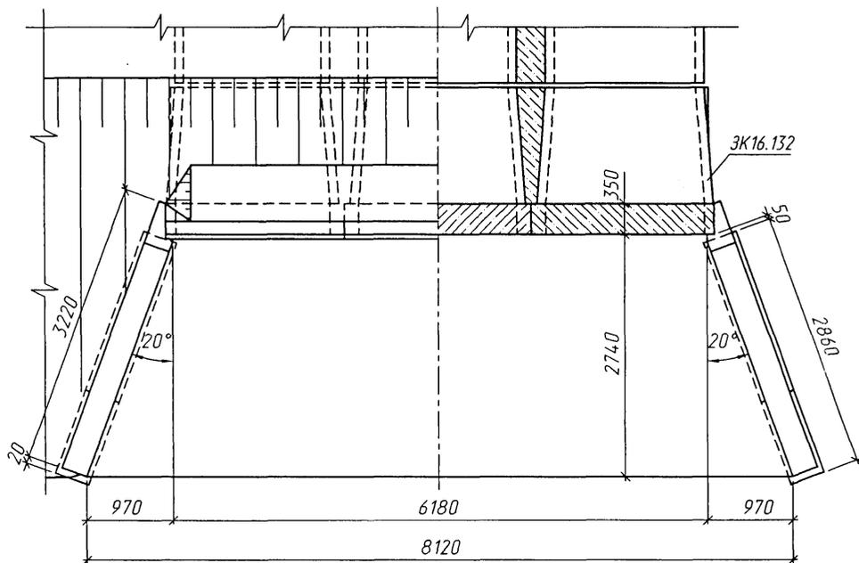
1. Звенья труб устанавливаются на блоки фундамента по слою цементного раствора М200 толщиной 20мм.
