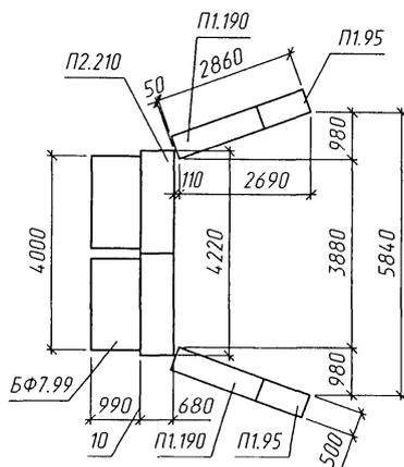
Спецификация блоков на оголовки
