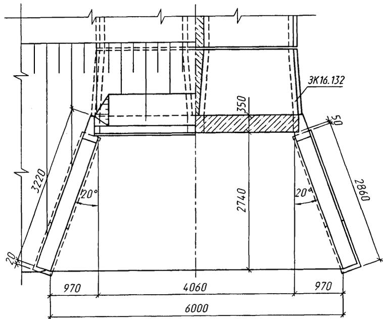
1. Звенья труб устанавливаются на фундамент по слою цементного раствора М200 толщиной 20мм.
