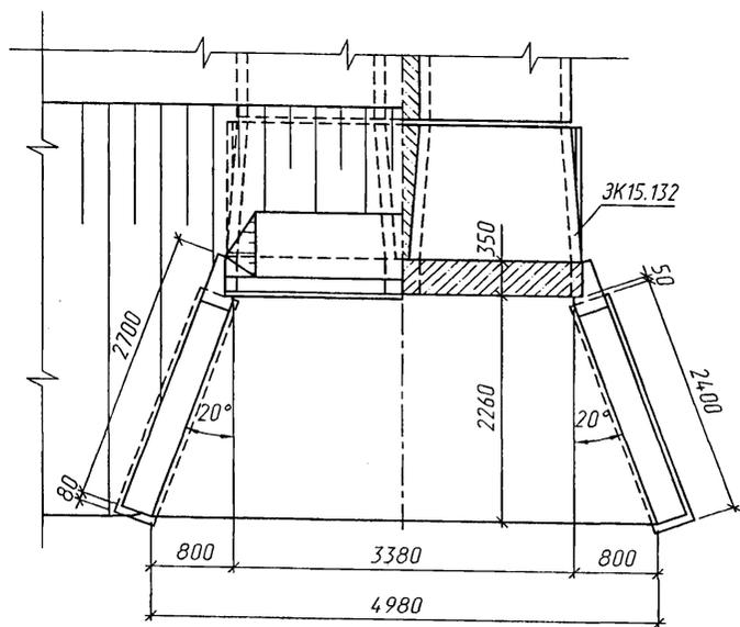
1. Звенья труб устанавливаются на блоки фундамента по слою цементного раствора М200 толщиной 20мм.
