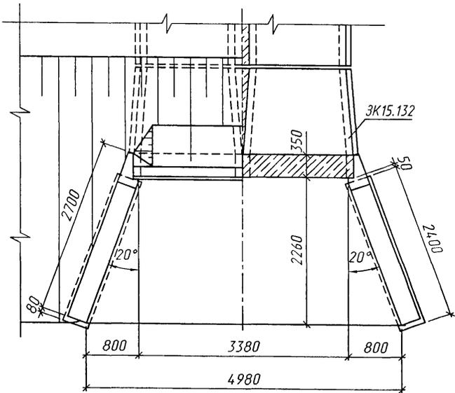
1. Звенья труб устанавливаются на фундамент по слою цементного раствора М200 толщиной 20мм.
